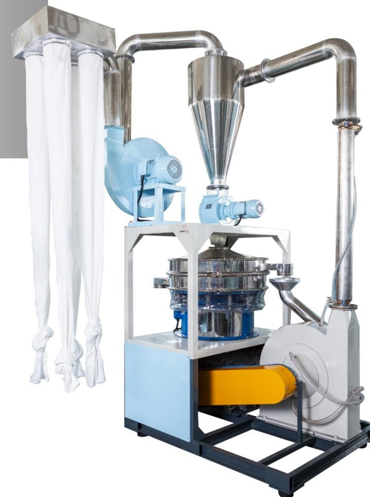
**NELLA SECONDA FASE** i frammenti di circa 10-12 mm<sup>2</sup> vengono trasformati in polverino vero e proprio attraverso l'utilizzo di un polverizzatore e un vibrovaglio speciale. Durante questo processo, i frammenti vengono ulteriormente ridotti in polvere con una granulometria finale compresa tra 300  $\mu$ m e 600  $\mu$ m.
